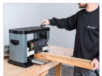
Ajuste de altura via manivela e escala
