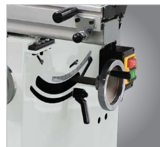
Volante manual para ajuste de altura do disco
