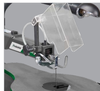
O dispositivo de sopra remove a serragem grossa da área de corte
