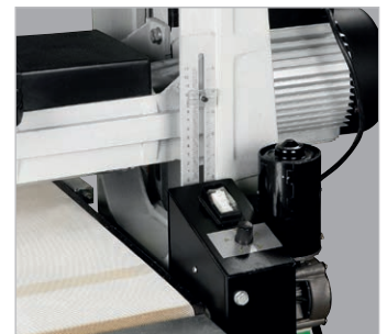
Ajuste da altura da unidade de lixa controlado pela escala
