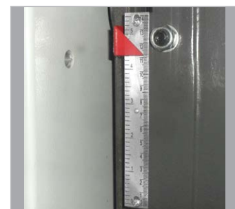
▶ A altura ajustada da mesa de trabalho também pode ser lida na escala
