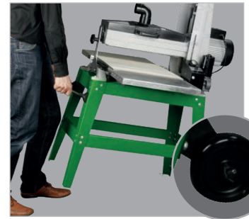
Chassi prático para o transporte e mudança do equipamento
