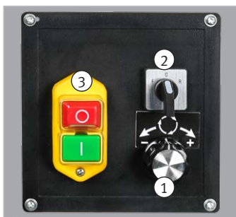
Regulação de velocidade variável em dois níveis
