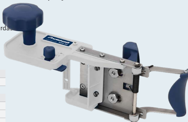
Ajuste de bordas sobrepostas permite corte preciso na borda sobreposta para peças retas e peças moldadas (redondas)
