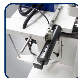
▶ Unidade de cavilha com posições grade 16 / 22 / 25 / 32
