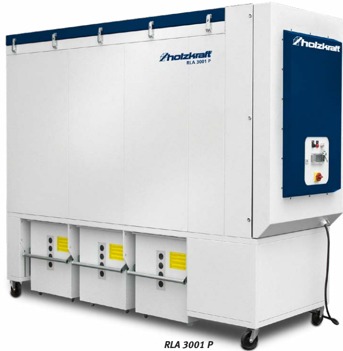
A limpeza ocorre com pulsos de ar comprimido que limpam o filtro de dentro para fora. A deformação mecânica resultante do filtro otimiza o grau de regeneração em caso de sujidade mais densa
