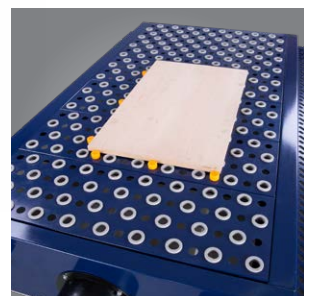
Batentes inseríveis para fixar a peça
