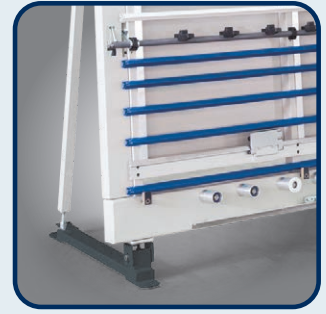
▶ Para impedir que a lâmina seja cortada num painel traseiro, a estrutura de ripas pode ser movida automaticamente
