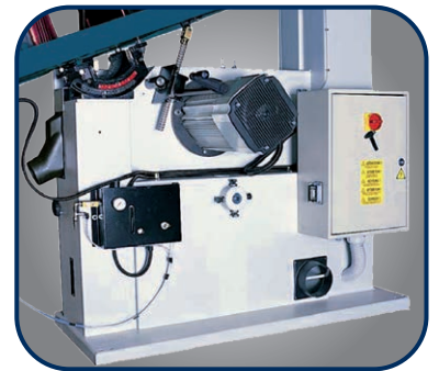
Inclinação da mesa através de cremalheira e chave estrela / delta automática
