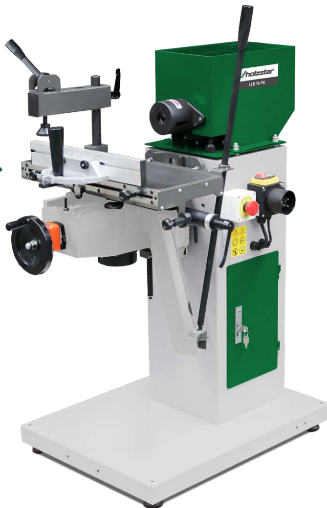
Perfuração em série através da unidade de cavilha com posições em grade 16/20/22/32 mm
