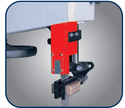
Guias de fita de serra inferior e superior com elementos de bronze
