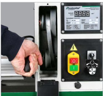
Não precisa de ferramentas para mudar o rácio das correias V
