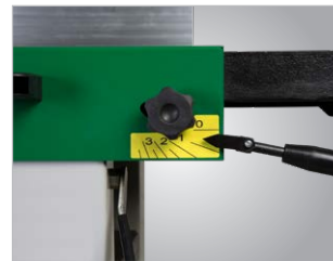
Ajuste da remoção de material através de alavanca de controlo
