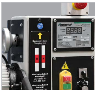
Regulação de velocidade variável em dois níveis
