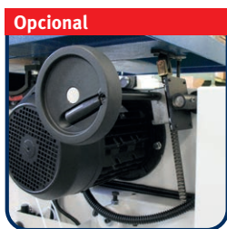
Dispositivo de inclinação de mesa com cremalheira
