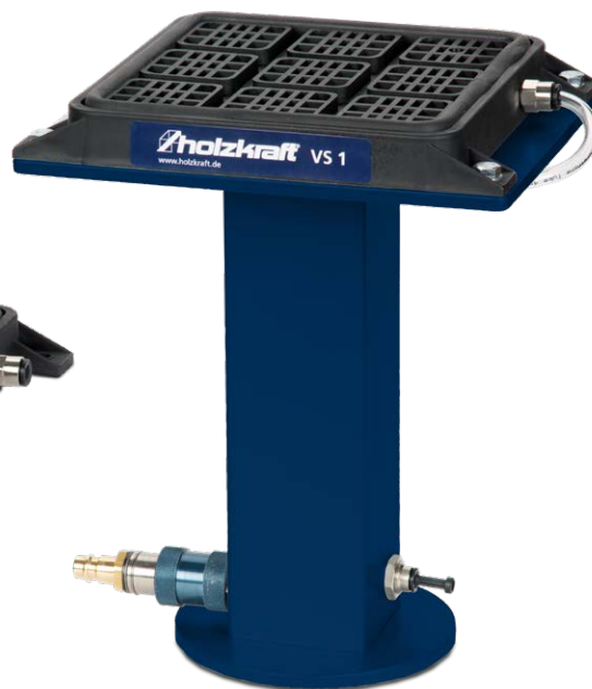
Unidade de fixação a vácuo VS 1 Fácil instalação e remoção da unidade de fixação a vácuo na mesa de trabalho, graças a um prático parafuso de alavanca
