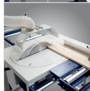
Rotação da lâmina da serra até 90°
