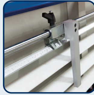
► Régua de ajustar comprimento de cortes verticais
