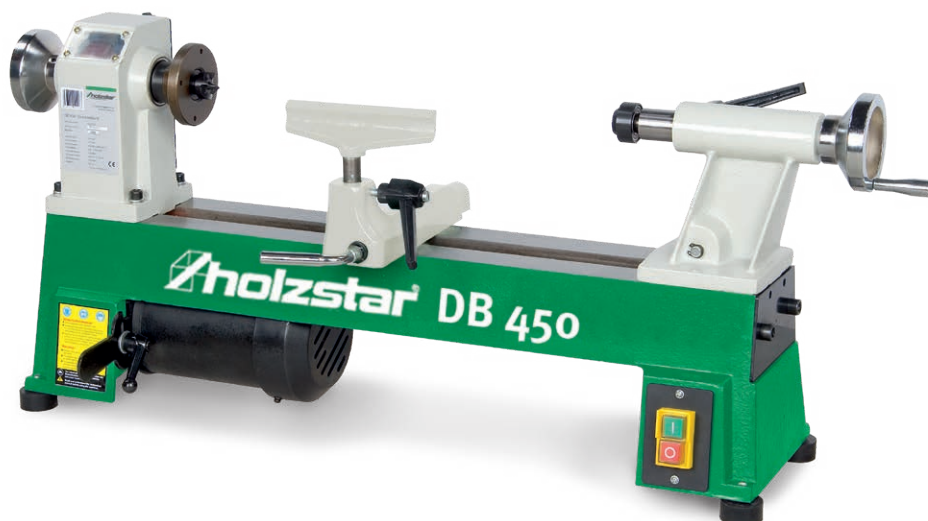
Pode fixar facilmente o contraponto através de uma alavanca. Avanço ajustável através de volante
